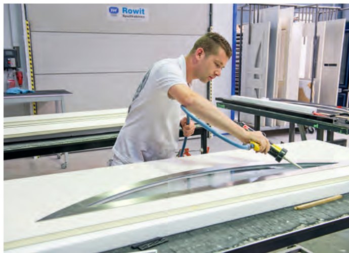
Afwerking van de naden van de beglazing van een deur met RVS-ornament
