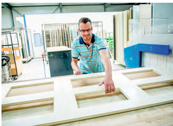
Met CNC-machinefrees uitgefreesde vorm voor deurpaneel
